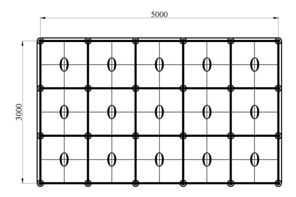
Schemat montażu stelaża SW-5x3 Assembly plan of steel galvanized mat grid SW-5x3
